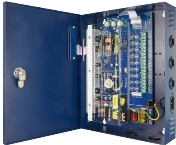
Caja de distribución de alimentación profesional. Se utiliza como fuente de alimentación centralizada para varias cámaras u otros dispositivos de seguridad ofreciendo protección individualizada.
